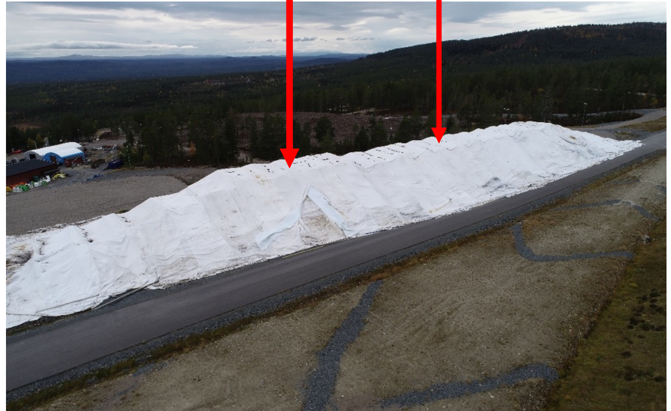
1 lager geotextil, 1 lager vaddering och 1 lager geotextil 29 % volymminskning
